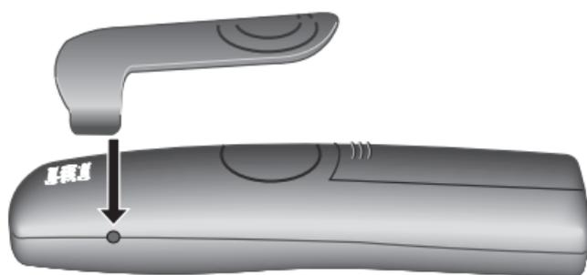
Gürtelclip auf der Rückseite des Mobilteils andrücken, bis seitliche Nasen in die Aussparungen einrasten.
